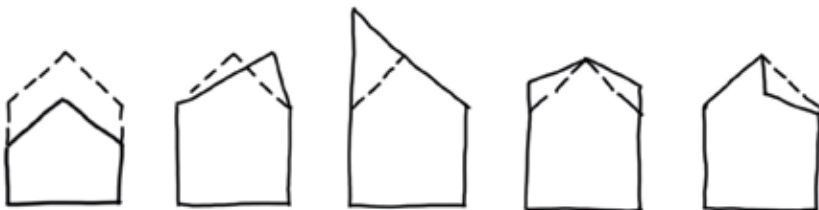
Des erreurs à éviter : surbaisser la toiture, modifier sa pente ou déplacer son faîtage.
