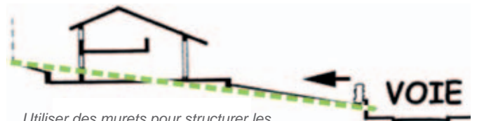
Utiliser des murets pour structurer les terrassements
